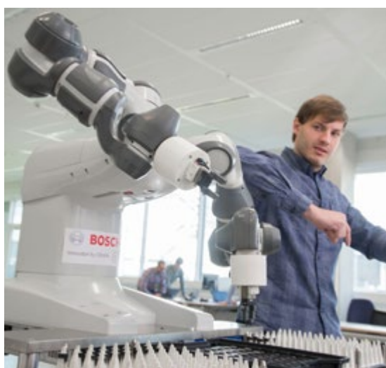
Der Zweiarm-Roboter lernt, indem er die Bewegung des Menschen nachmacht. Durch seinen Körperbau verfügt er über Fähigkeiten, die denen eines Menschen ähneln.
