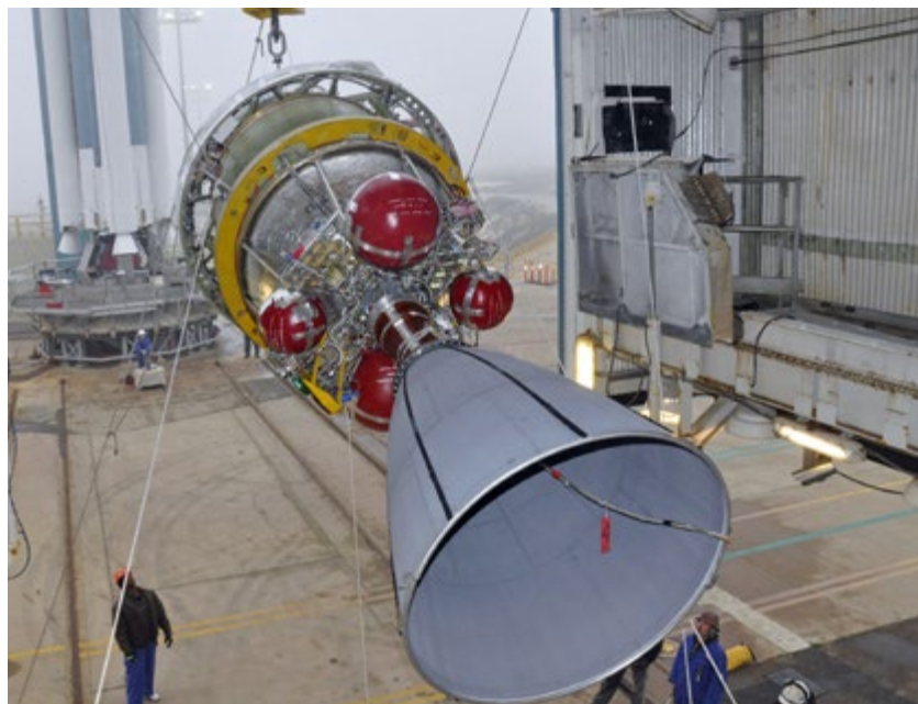
Die zweite Stufe der Rakete Delta II für die NASA-Mission OCO-2 wird auf der Vandenberg-Air-Force-Basis in Kalifornien in Position gebracht
