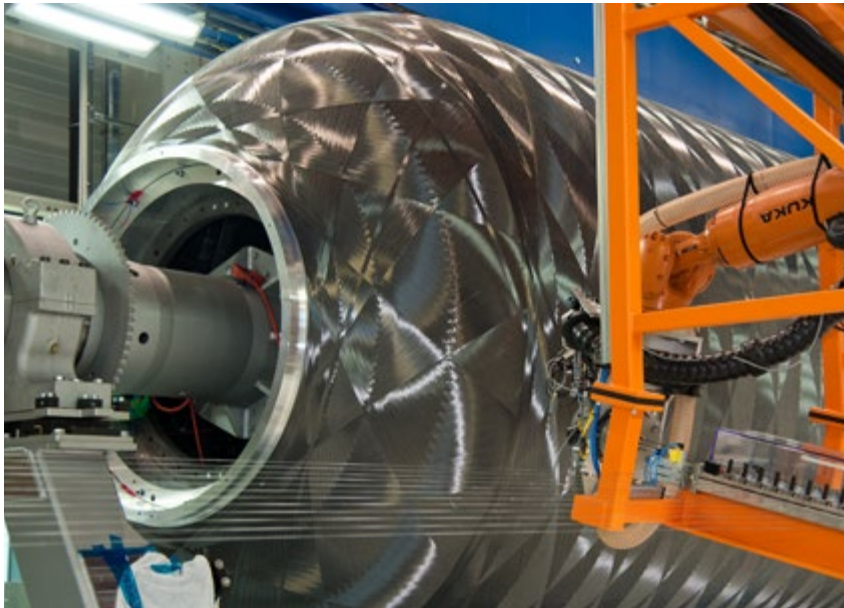
Das Boostergehäuse der ARIANE 6, beim DLR Stuttgart und Augsburg in Kooperation mit MT Aerospace entwickelt, besteht nahezu vollständig aus kohlenstofffaserverstärktem Kunststoff (CFK)
