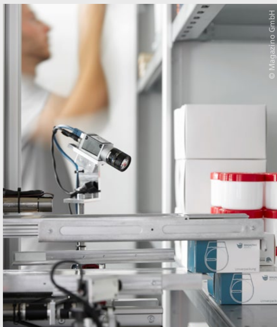
Der Roboter TORU kann mittels Kamera und Kreuzlaser sowie einer drehbaren Hubsäule in Regale schauen und parallel mit menschlichen Mitarbeitern im Lager arbeiten
