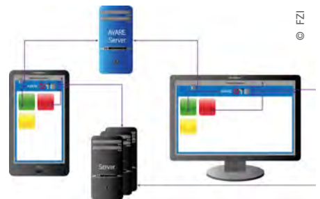
AVARE kapselt eine Anwendung und kontrolliert ihre Interaktion mit der Umwelt. Ein AVARE-Server verteilt die Einstellungen an alle Endgeräte.
