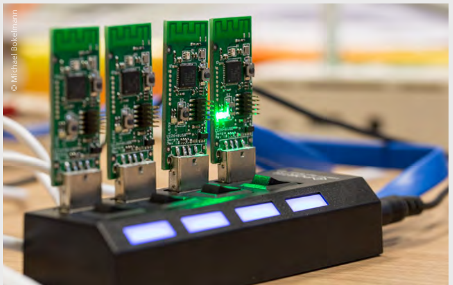
Auf vier ZigBee-Modulen, auf Basis von 8051 Prozessoren, wird die Software entwickelt und getestet
