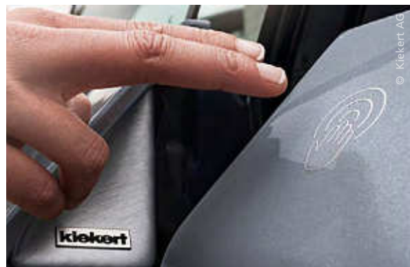
Mit einem Fingerabdruck identifiziert sich der Fahrer und kann allein durch eine Berührung die Tür entriegeln
