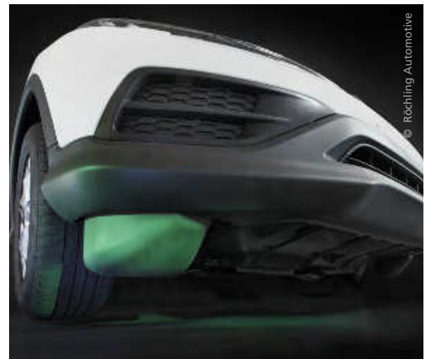
Die Staulippen minimieren den Luftwiderstand und helfen dabei, die Emission von Klimagasen zu reduzieren
