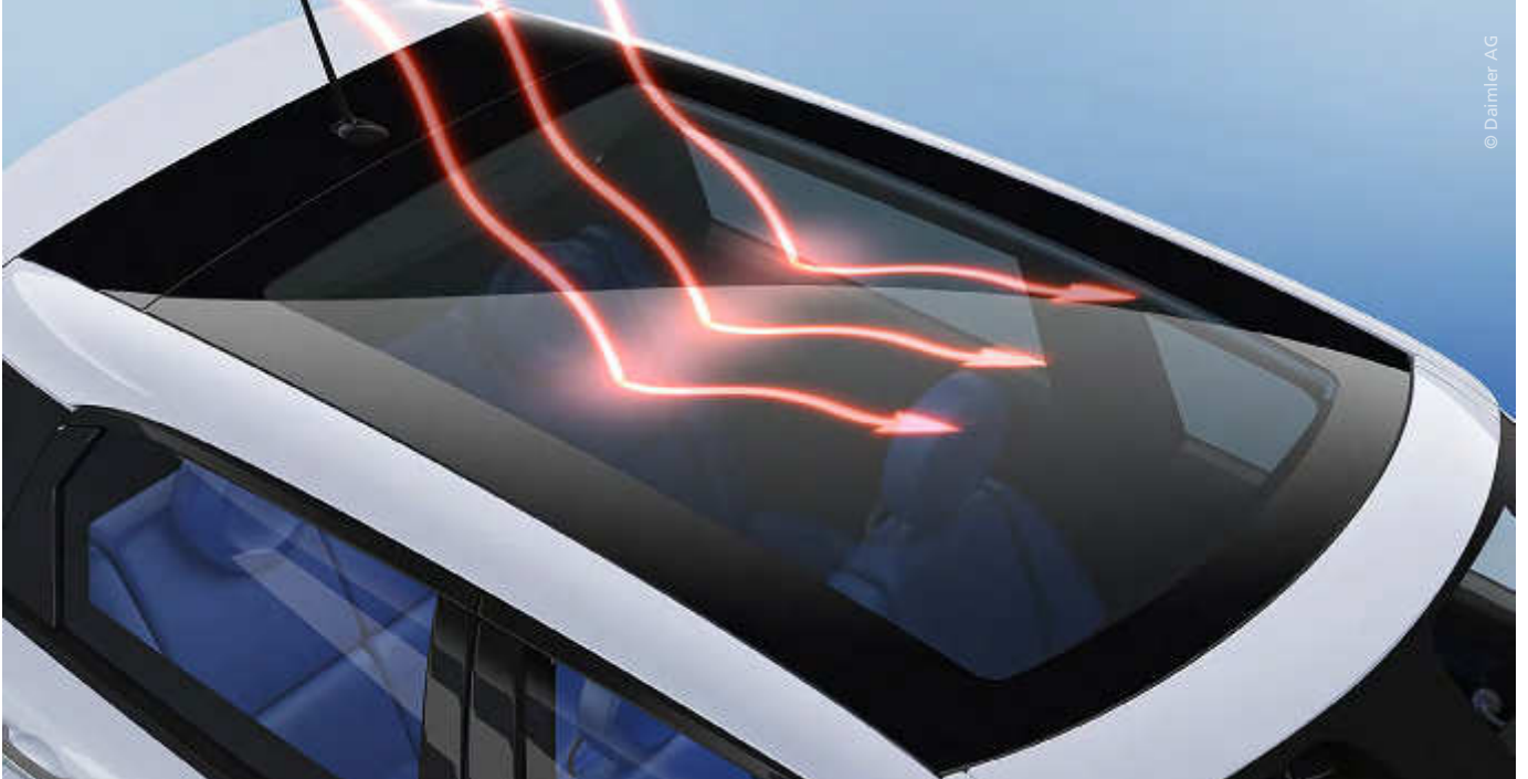
Das Polycarbonatdach im neuen smart fortwo absorbiert Infrarotstrahlung
