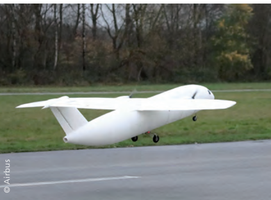
THOR (Testing Hightech Objectives in Reality) ist ein flugfähiges Airbus-Minutestflugzeug aus dem 3D-Drucker (siehe auch Titelmotiv)
