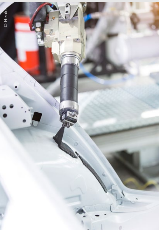
Der Kleber kommt hier nicht aus einer Tube, sondern wird mittels eines Roboterarms hochpräzise in der richtigen Menge automatisch aufgetragen
