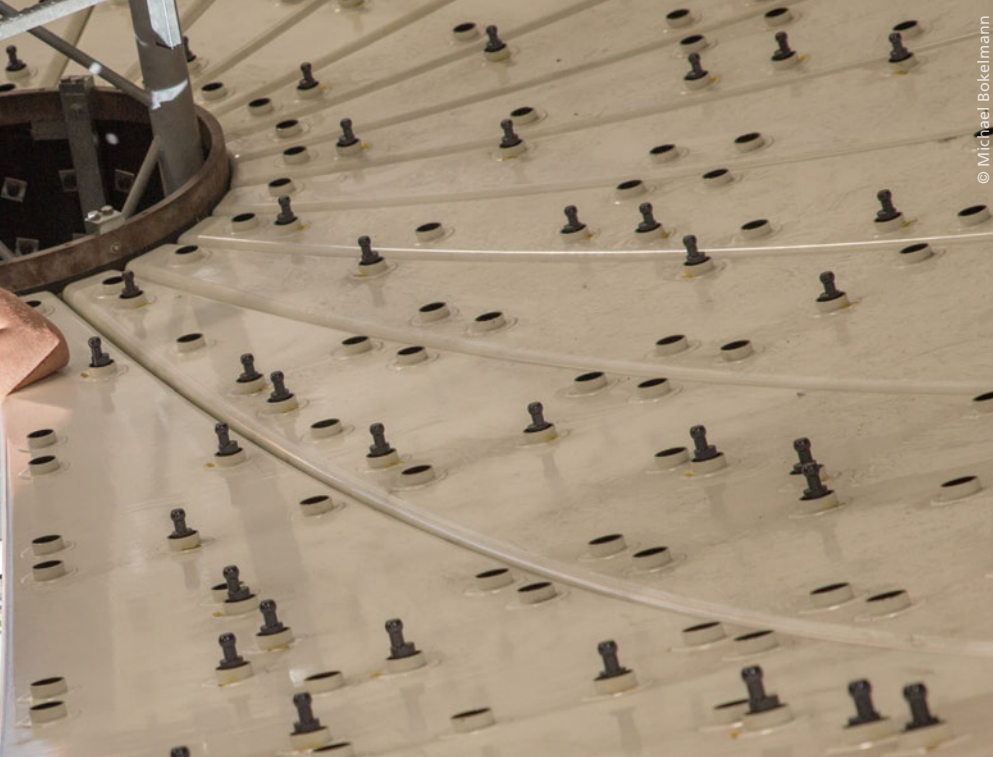
Stellmotoren, auf denen schließlich die aufgesetzten Reflektoren hochpräzise und automatisiert ausgerichtet werden können.
