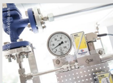
Detailaufnahme der Versuchsanlage zur Methanisierung von Wasserstoff
