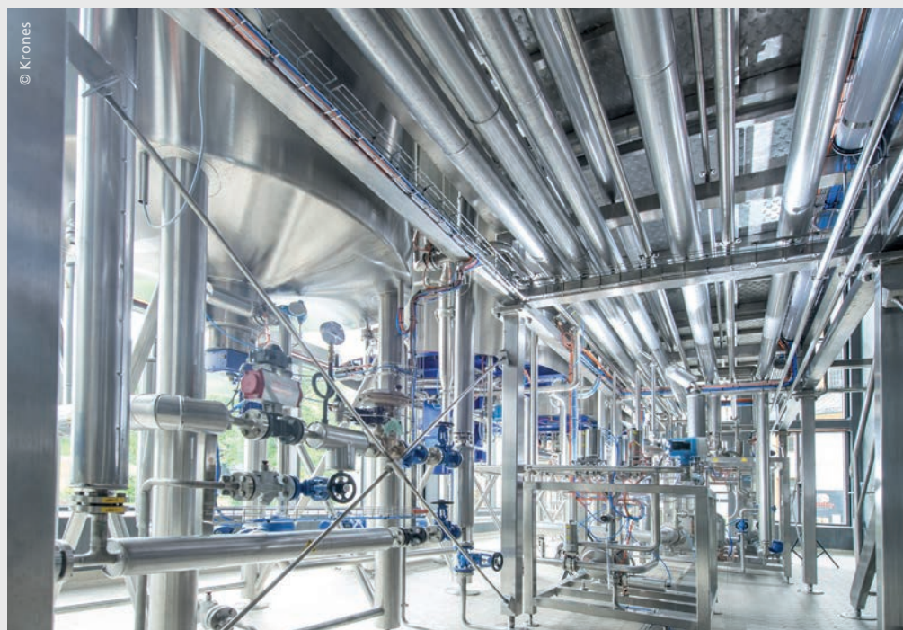
Der Steinecker MicroCube ist eine Brauanlage für kleine Chargen, die ganze Anlage lässt sich auf weniger als 90 Quadratmetern unterbringen
